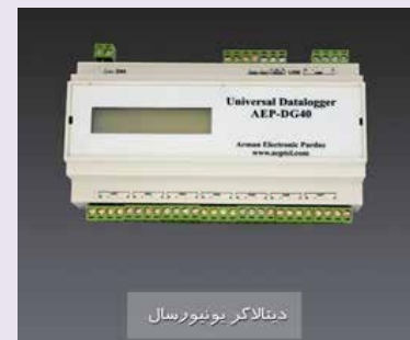
دیتالاگر دما و رطوبت با مودم GSM داخلی
